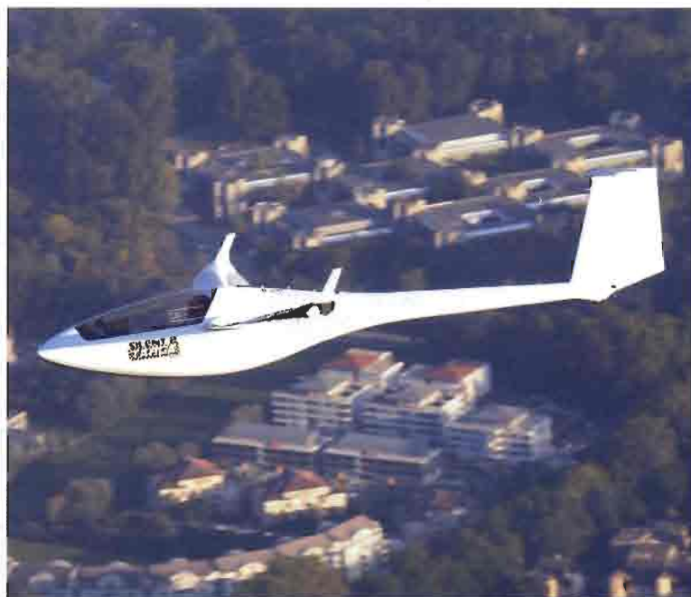
Le Silent2 Targa est un planeur performant à décollage autonome, avec 40 points de finesse pour 15,50 m d'envergure.
