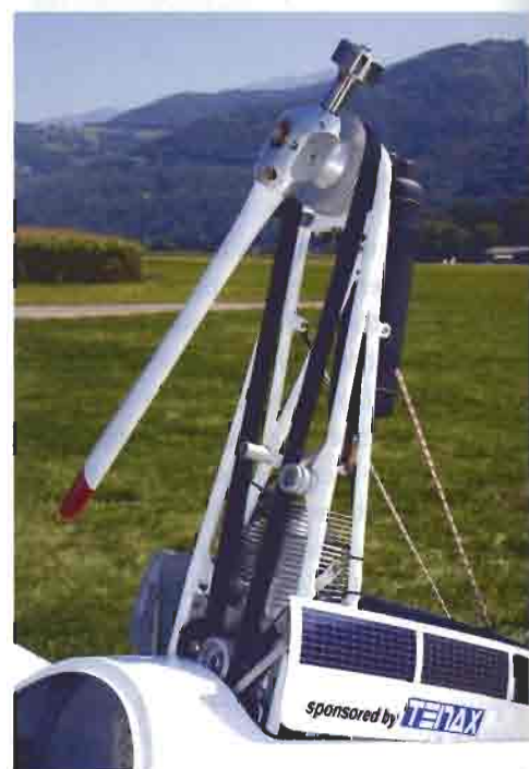
Alisport est l'un des rares constructeurs à fabriquer à la fois la cellule et la motorisation de l'appareil. L'hélice monopale est caractéristique.
