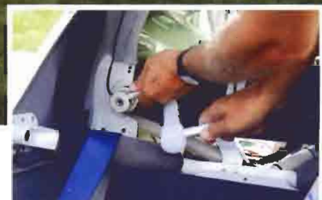
Le montage de ce planeur ULM est aisé avec le branchement automatique des commandes. Il peut même se faire seul si la remorque est adaptée.
