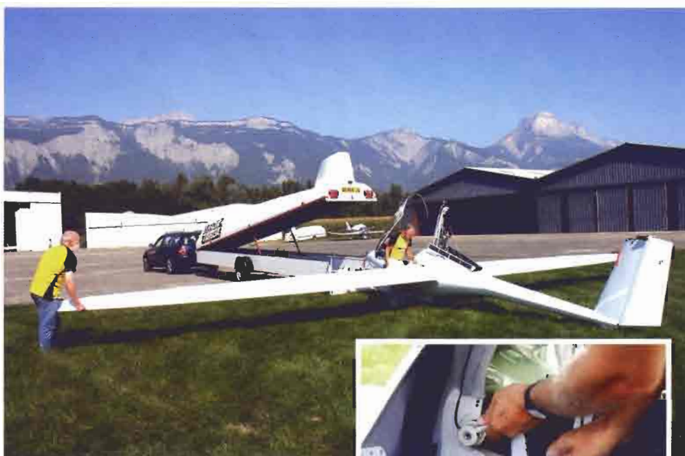
Le montage de ce planeur ULM est aisé avec le branchement automatique des commandes. Il peut même se faire seul si la remorque est adaptée.
