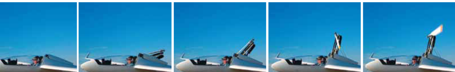
In soli 14 secondi si estrae il motore pronto per l'avvio
