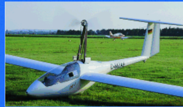
GANZ MOTORISIERTES SEGELFLUGZEUG: Bei der Silent AE-1 klappt nur der Propeller aus.
