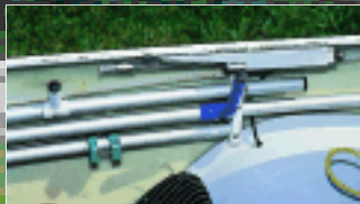
BEDIENKONSOLEN für die Antriebseinheit an der rechten Bordwand (oben) und Gas, Wölb- und Bremsklappen, Trimmung links.
