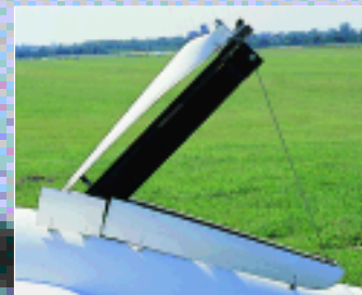
DER PROPELLER klappt im Ruhezustand zusammen. Die Pedale lassen sich nur am Boden einstellen.
