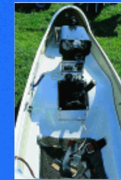
DAS GERAUMIGE COCKPIT bietet auch großen Piloten Platz. Die Haube wird aus Gewichtsgründen gesteckt.
