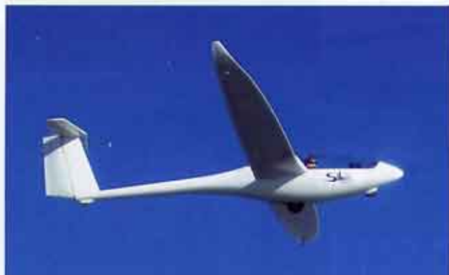
Gut zu erkennen: der elliptische Grundriss des Flügels.
