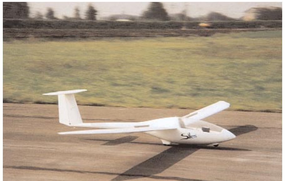
Il volo di collaudo del Silent di Fornaciari e Capodaglio. Il particolare carrello a due ruote in linea permette di avere sempre un controllo perfetto in atterraggio.
