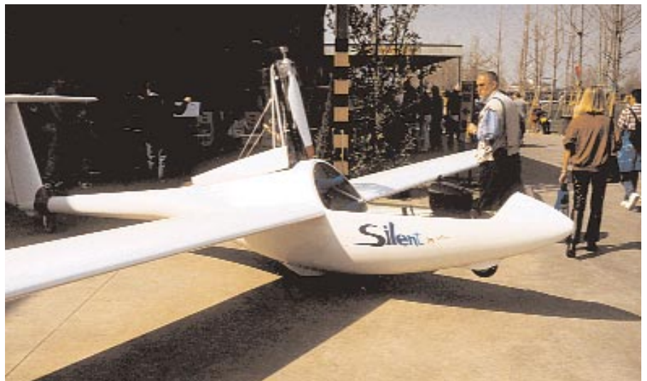
Un Silent full-size, in versione "autosufficiente", motorizzato con una pinna retrattile e dotato di una strumentazione supercompleta con GPS e Logger.
