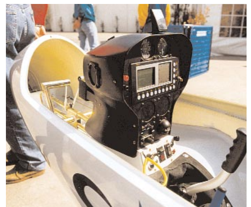
Un Silent full-size, in versione "autosufficiente", motorizzato con una pinna retrattile e dotato di una strumentazione supercompleta con GPS e Logger.
