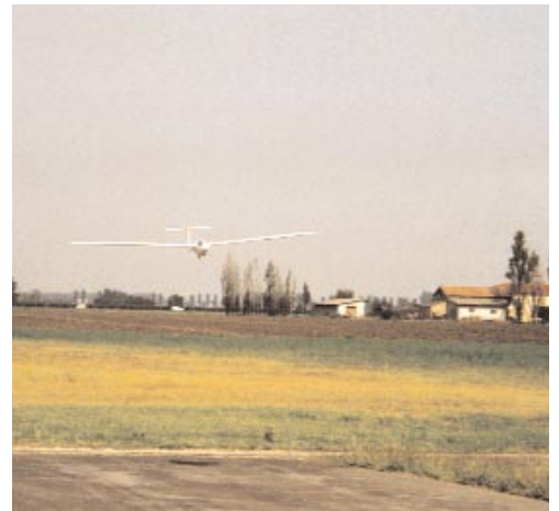
Il volo di collaudo del Silent di Fornaciari e Capodaglio. Il particolare carrello a due ruote in linea permette di avere sempre un controllo perfetto in atterraggio.
