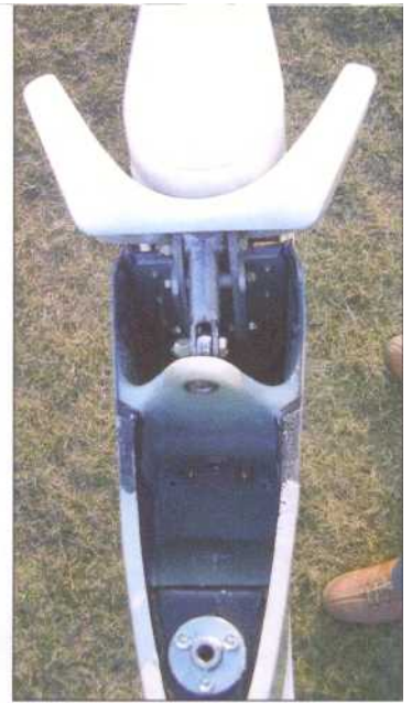
L'attacco del piano di coda, visto dall'alto
